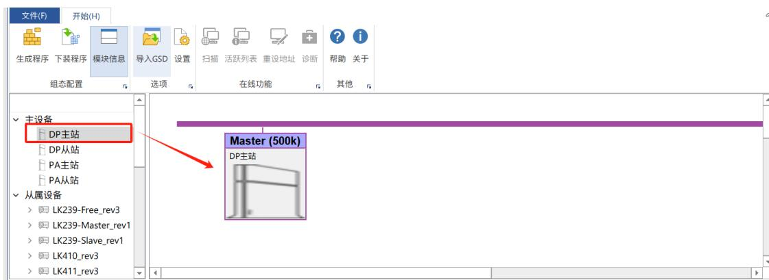
修改主站通讯波特率，默认为 500kbps，双击主站图标，根据需要通讯的仪表的波特率进行修改。主站模块只需要修改波特率，其他参数直接用默认的即可。
